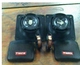
Fig. 4: Detalle interno de la pareja sensor – transductor TWEETER FT-206. Su elemento activo es un material piezoeléctrico al cual se le adiciona una bobina a manera de filtro.
